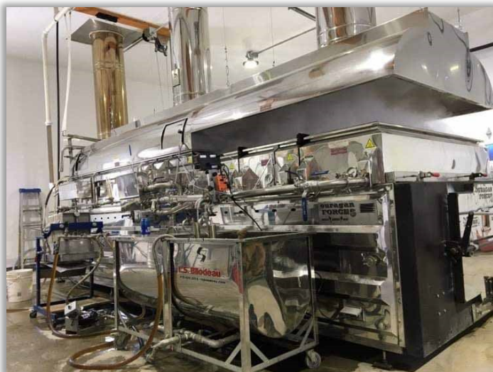
L'évaporateur géant qui permet la production de sirop: avec 37 000 entailles, l'équipement doit être à la hauteur des attentes!
